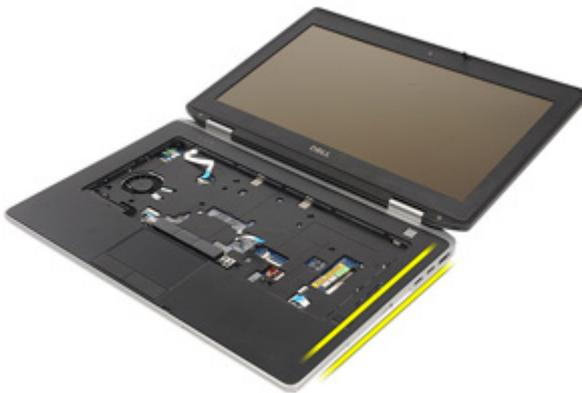
17. Continuez d'utiliser la pointe en la faisant glisser le long des côtés haut et gauche du repose-mains jusqu'à ce que tous les cliquets soient libérés.
