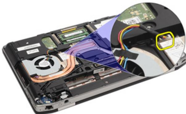
8. Desserrez les vis fixant le dissipateur thermique.
