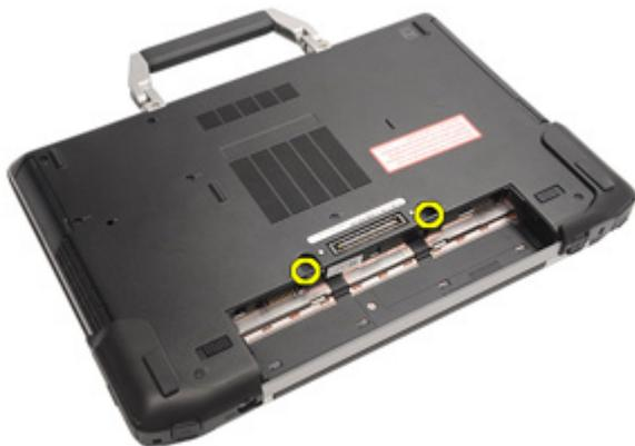
5. Retirez les vis qui fixent le clavier au système.
