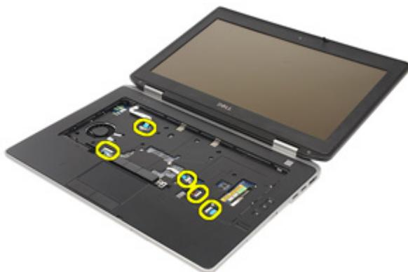
16. À l'aide d'une pointe en plastique, soulevez délicatement le coin supérieur droit du repose-mains et faites glisser la pointe vers le côté droit du repose-mains pour libérer les cliquets.
