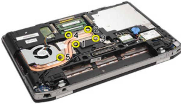
9. Retirez du système le bloc dissipateur thermique.
